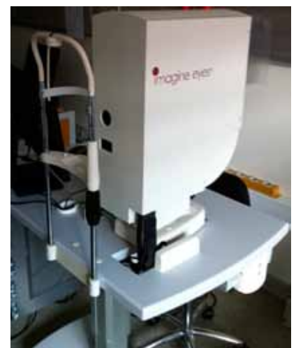
Figur 1: Billedoptagelse med en adaptiv optik scanner minder på mange måder om fotografering med et fundus camera med en hagestøtte til at indstille patientens øje og en optageenhed.
